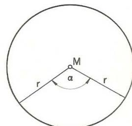
**Zentriwinkel oder Mittelpunktswinkel  $\alpha$ :** Der Scheitelpunkt des Winkels liegt im Mittelpunkt (Zentrum) des Kreises, die Schenkel bilden Radien.
