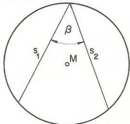
**Peripheriewinkel oder Umfangswinkel  $\beta$ :** Der Scheitelpunkt des Winkels liegt auf der Kreislinie, die Schenkel bilden Sehnen  $s_1, s_2$ .
